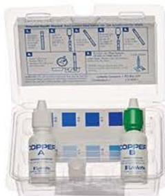
ΚΙΤ χρώμα διάγραμμα για τη μέτρηση του χαλκού 0,05 έως 1,0 ppm.
